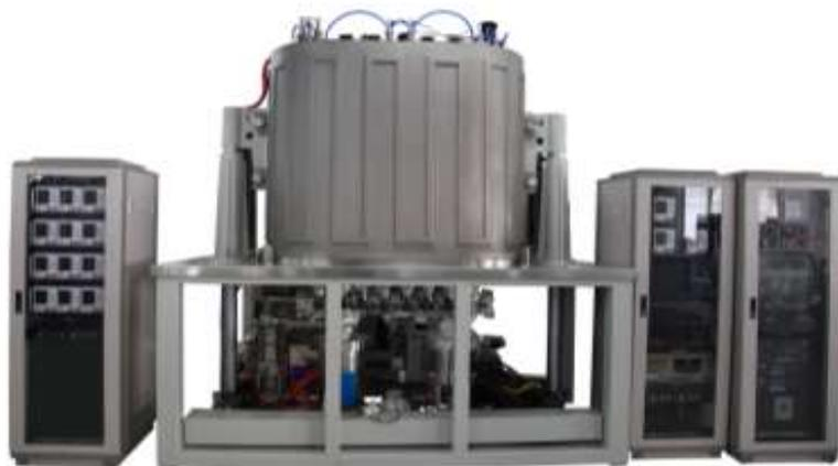
图 5 32 工位超高真空自动排气系统实物图
