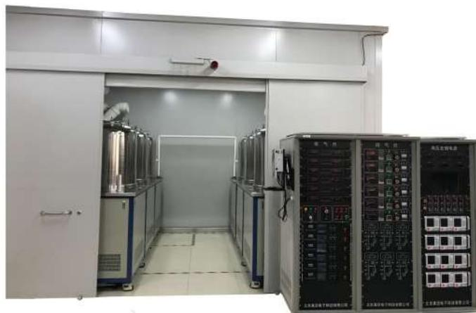
图 9 X 射线防护超高真空排气系统实物图
