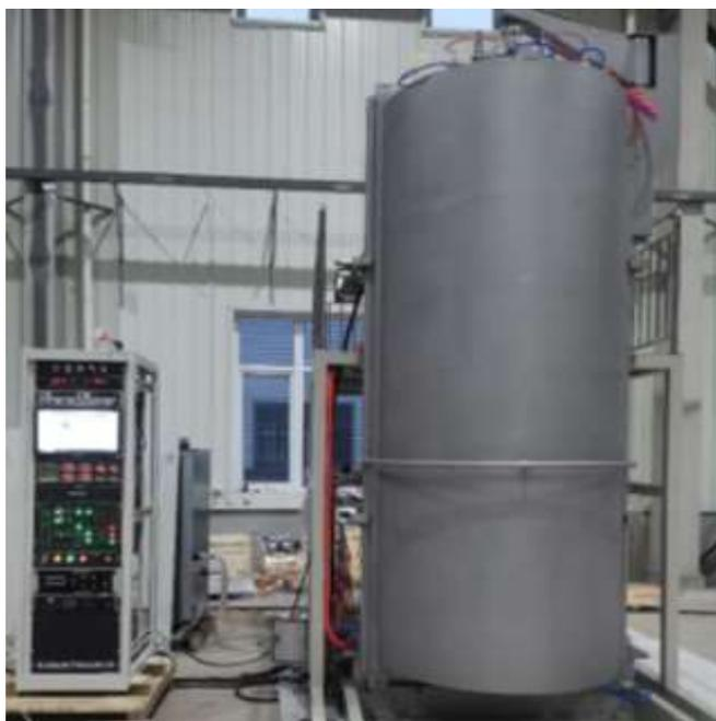
图 10 超大型超高真空排气系统实物图
